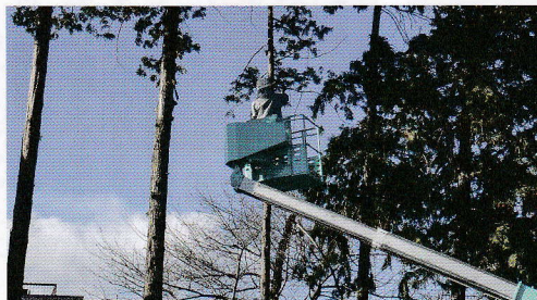
高所作業車を使い枝下ろし作業を実施
